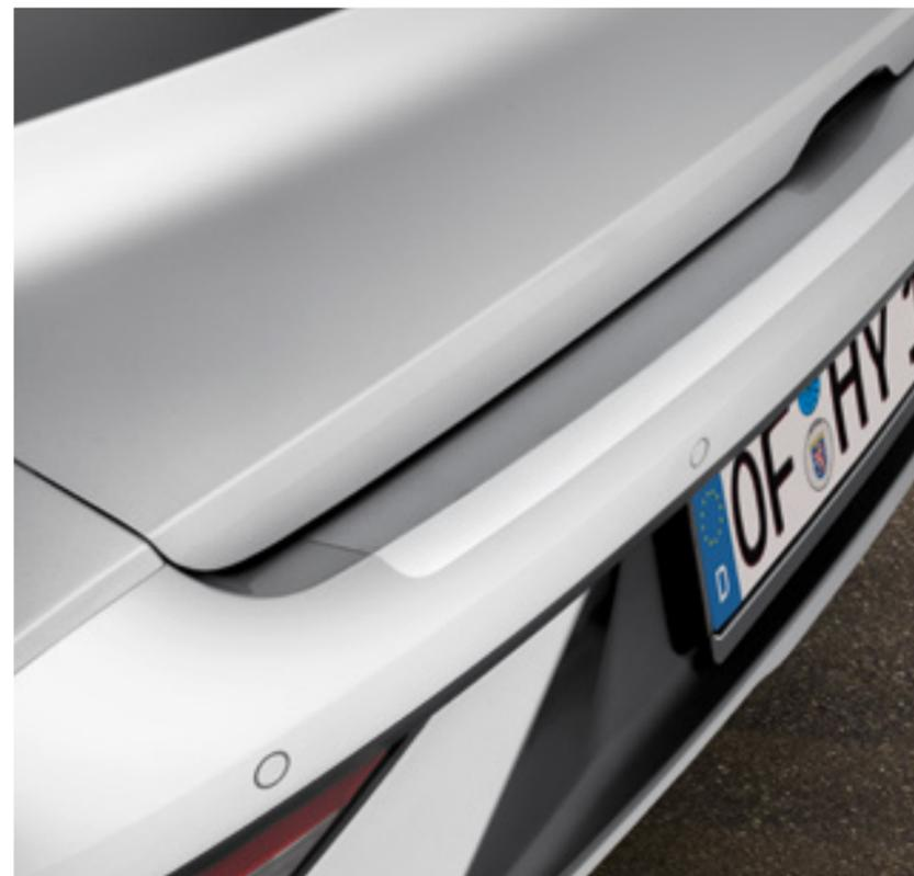
Lámina adhesiva de protección para el paragolpes trasero, transparente, Q0272ADE50TR
