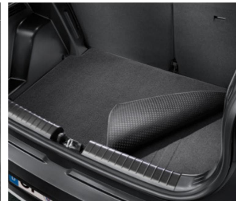
Bandeja protectora rígida para el suelo del maletero,
