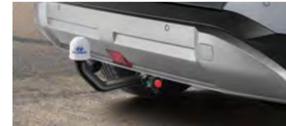
Enganche de remolque desmontable, BE281ADE00 (ICE/HEV)
